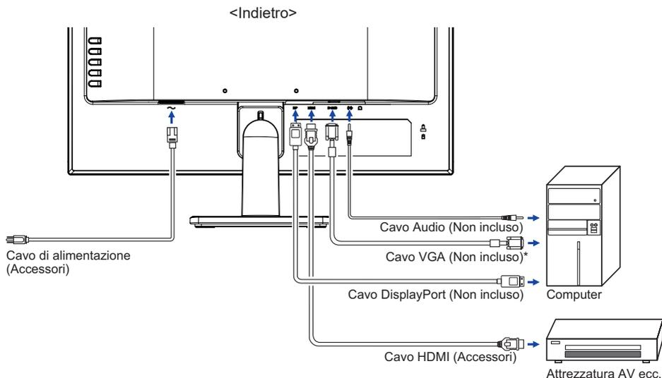
\* Il cavo VGA non è fornito con il monitor. Se usate un cavo VGA di scarsa qualità si potrebbero avere interferenze elettromagnetiche. Si prega di contattare il Centro di Supporto di Iiyama nel vostro paese se si desidera collegare il monitor tramite l'ingresso VGA.
