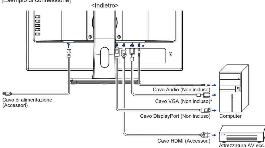
\* Il cavo VGA non è fornito con il monitor. Se usate un cavo VGA di scarsa qualità si potrebbero avere interferenze elettromagnetiche. Si prega di contattare il Centro di Supporto di Iiyama nel vostro paese se si desidera collegare il monitor tramite l'ingresso VGA.
