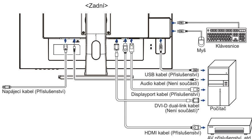
\* DVI dual-link kabel není součástí dodávky monitoru. Pokud používáte DVI dual-link kabel nízké kvality, může dojít k elektromagnetického rušení. Obraťte se prosím na servisní středisko iiyama ve Vaší zemi, pokud se chcete připojit monitor přes DVI vstup.
