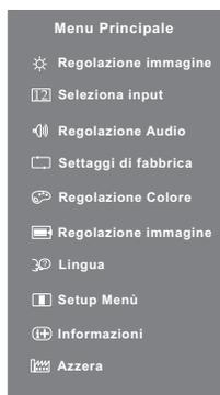
Per esempio, per settare il posizionamento in verticale, selezionare Menù dallo Regolazione Immagine. Premere il tasto ENTER quindi selezionare "Geometria" tramite i tasti ◀/▶. Viene visualizzata una pagina di regolazione dopo aver premuto il pulsante ENTER. Quindi selezionare "Posizione V." tramite i tasti ◀/▶.
