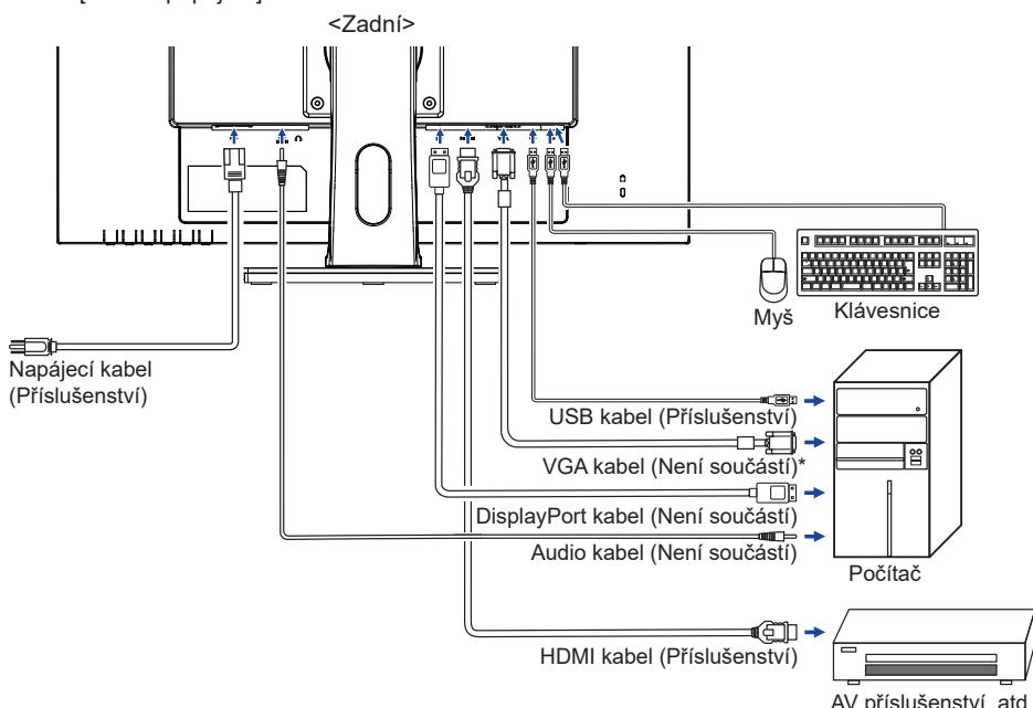
\* VGA kabel není součástí dodávky monitoru. Pokud používáte VGA kabel nízké kvality, může dojít k elektromagnetickému rušení. Obraťte se prosím na servisní středisko iiyama ve Vaší zemi, pokud se chcete připojit monitor přes VGA vstup.
