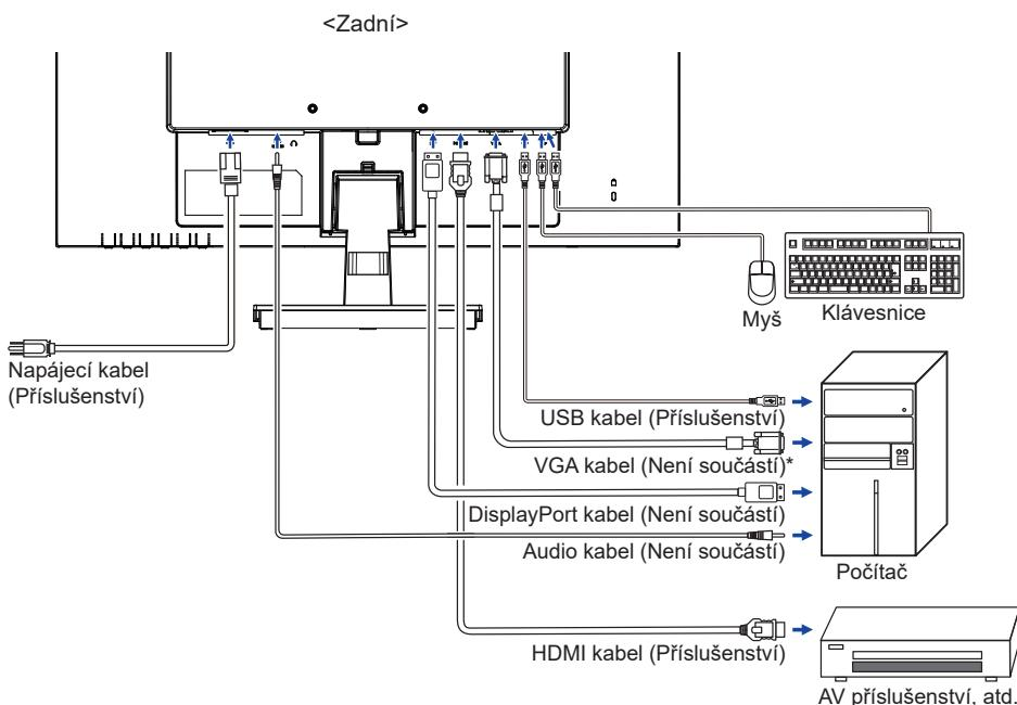
\* VGA kabel není součástí dodávky monitoru. Pokud používáte VGA kabel nízké kvality, může dojít k elektromagnetickému rušení. Obraťte se prosím na servisní středisko iiyama ve Vaší zemi, pokud se chcete připojit monitor přes VGA vstup.
